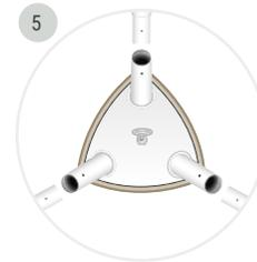
Verbinde nun die 3 Beine mit dem Oberteil 3, indem du diese zusammensteckst. Achte auch hier darauf, dass die Sperrfedern vollständig einrasten. Anschließend kannst du deine Federwaage an der Aufhängung befestigen.
